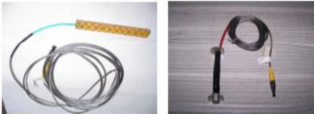
Figura 25. Sensores de fibra óptica con diferentes técnicas de encapsulado. Adoptado de Sundaram, Kesavan, Parivallal, Ahmed, & Ravisankar (2011).
