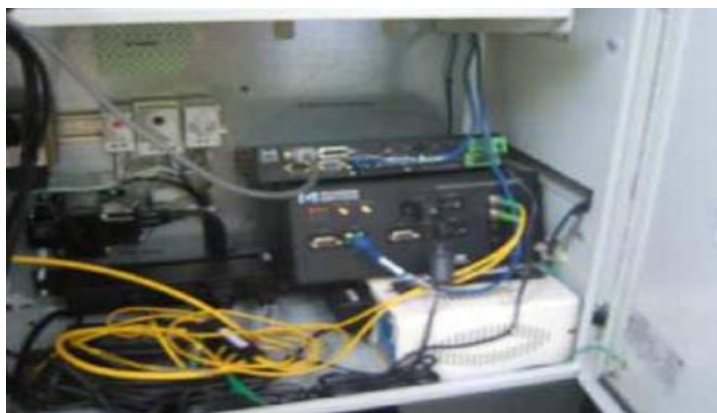
Figura 42. Sistema de sensores y adquisición de datos. Adoptado de Micron Optics (2008).
