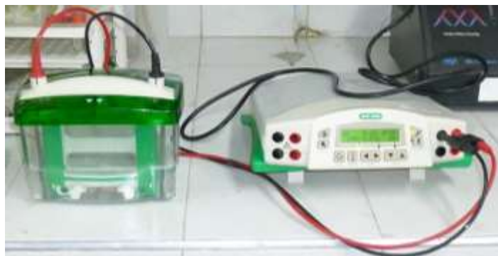
Figura 4. Montaje empleado para los procedimientos electroforéticos. Fuente: Autora.
