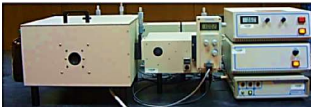
Figura 5. Espectrofluorímetro Photon Technology International, Quantamaster QM-40 . Fuente: Autora.
