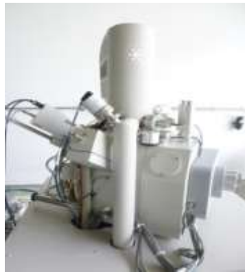
Figura 6. Der.: Inmovilización de la muestra sobre una mica de muscovita. Izq.: Microscopio electrónico QUANTA FEG 650. Fuente: Autora.
