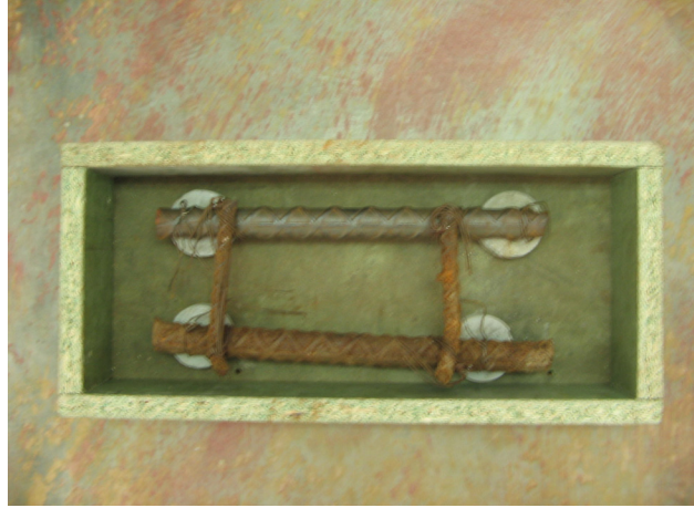
Figura 2.12 Prueba de corrosión del acero
