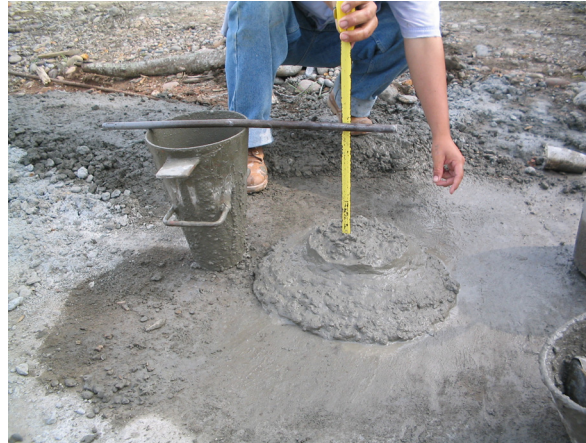
Figura 2.2 Medida de asentamiento en obra
