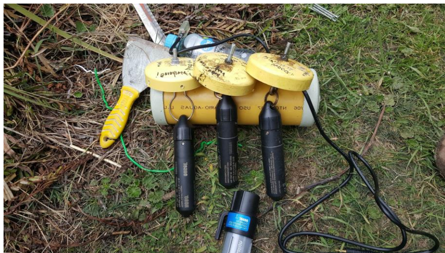
Foto A4. Configuración e instalación de los diver
