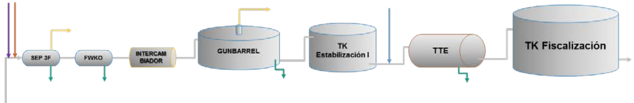
Figura 16. Esquema generalizado de tratamiento de crudos viscosos espumosos con separador trifásico y eliminador de agua libre.
