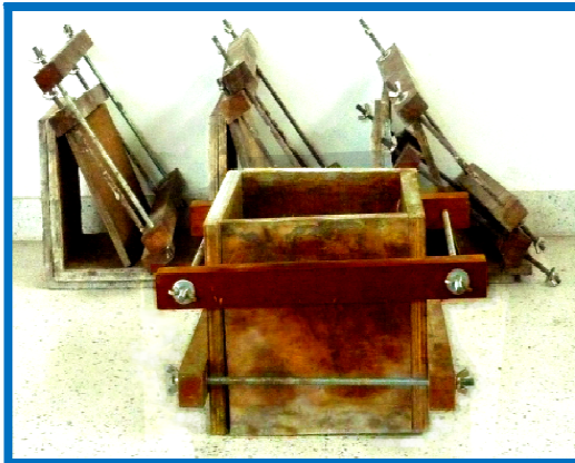
Figura 9. Formaleta utilizada en la elaboración de las probetas
