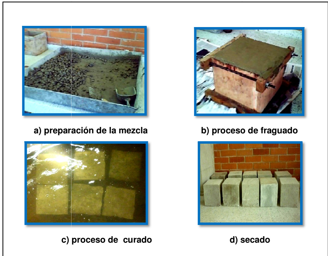
Figura 10. Proceso de elaboración de las probetas
