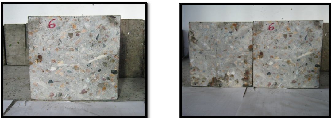
Figura 21. Inspección para una probeta al 50% de carga aplicada
