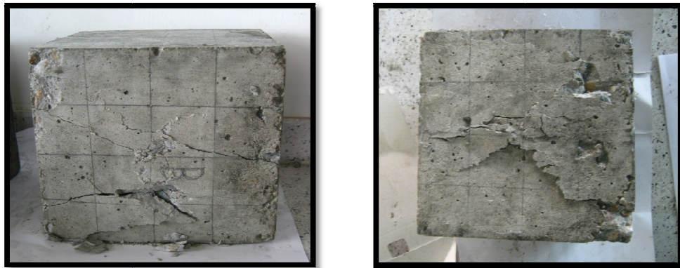
Figura 20. Probetas al 100% de la carga aplicada
