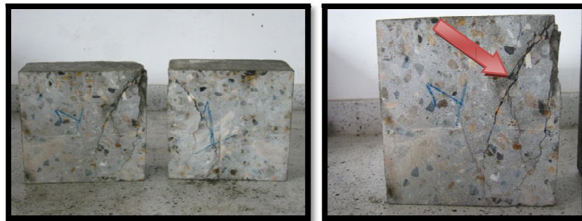
Figura 22. Inspección para una probeta al 100% de carga aplicada.
