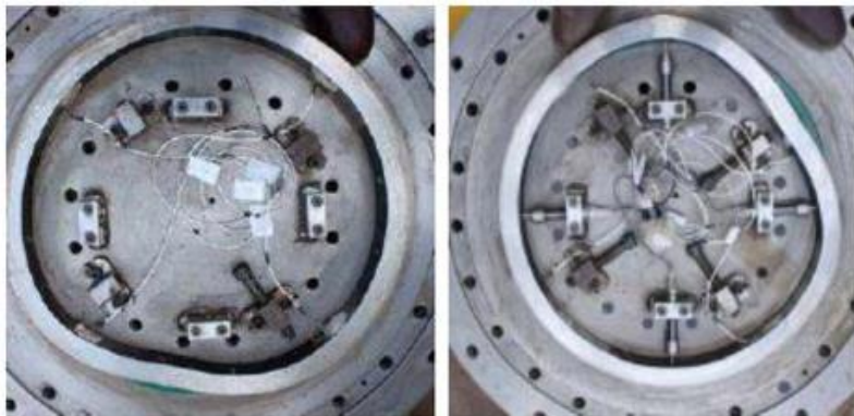
Figura 3: Muestras de anillos de colapso posteriores a la prueba.
