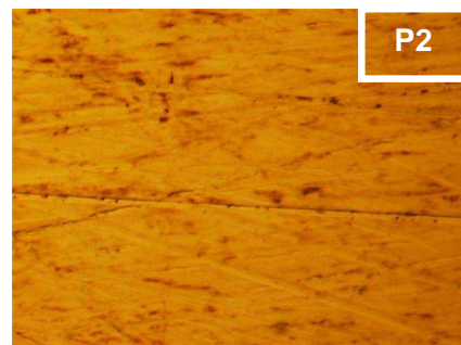
Figura 35. Área de exposición lámina de acero API 5L Gr. B. Probeta P2. 50x
