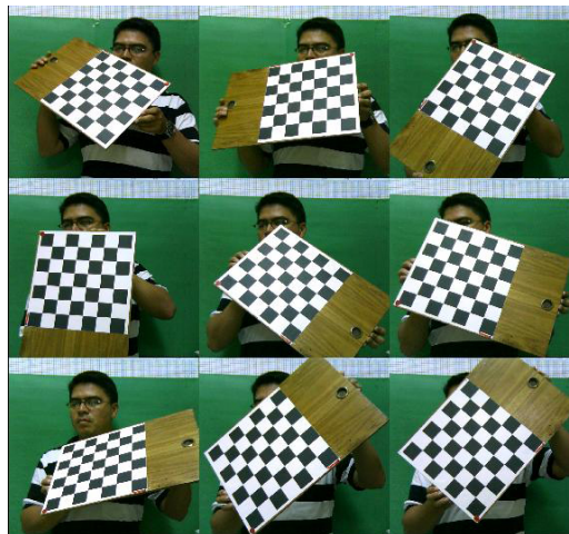
Figura 33. Una de la serie de imágenes tomadas en el proceso de calibración.
