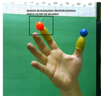
Figura 41. Región de búsqueda del marcador proporcionada por el filtro de Kalman.
