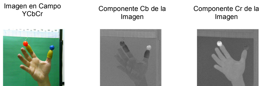
Figura 35. Extracción de la componente Cb y Cr de la imagen.
