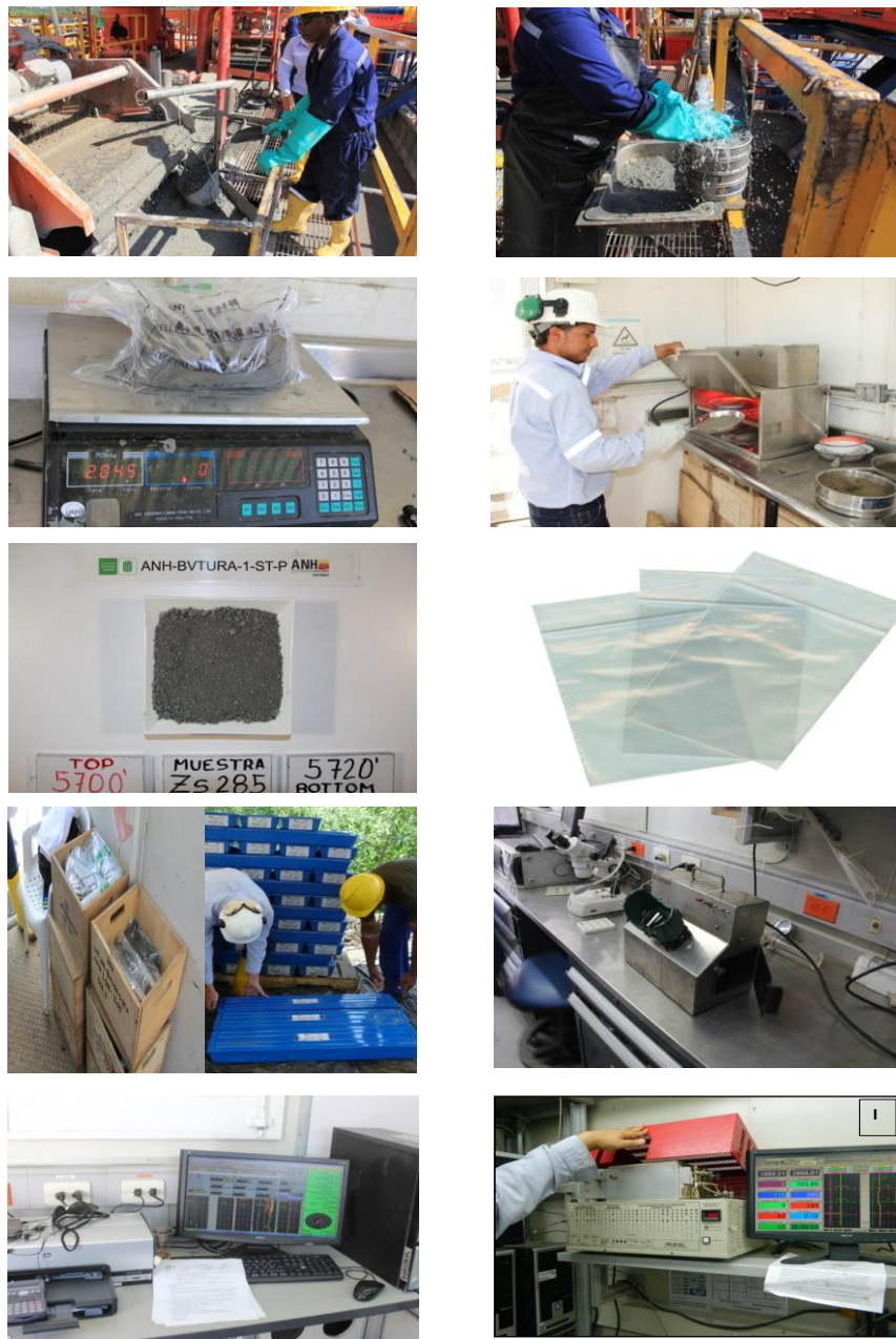
Figura 13. Proceso de recolección de muestras de ripios. a. Toma de muestra de la zaranda vibratoria. b. Lavado y tamizado de la muestra recuperada. c. Peso de la muestra de zanja. d. Secado de la muestra en el horno. e. Plantillas para fotografías de muestras de zanja. f. Bolsa de cierre hermético para la preservación de muestras de zanja. g. Almacenamiento de cajas. h. Laboratorio para análisis de muestras. i. Visualización de la master (Drill monitor) j. Cromatografía y pantalla de transmisión de datos en tiempo real.
