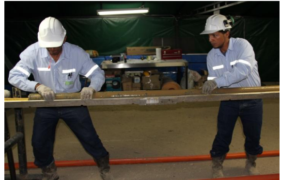
Figura 12 Proceso de corazonamiento. a. Pesca del barril. b. Salida del núcleo. c. Descripción del núcleo. d. Medición, orientación y marcación del núcleo. e. Preservación de los núcleos. f. Empaque y almacenamiento.
