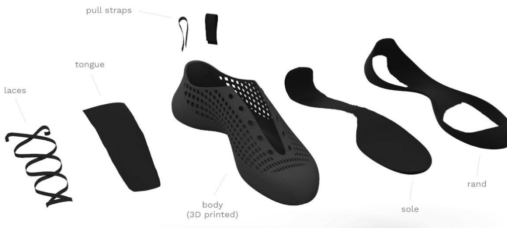
Figura 6 Despiece explosionado de zapato ATHOS
