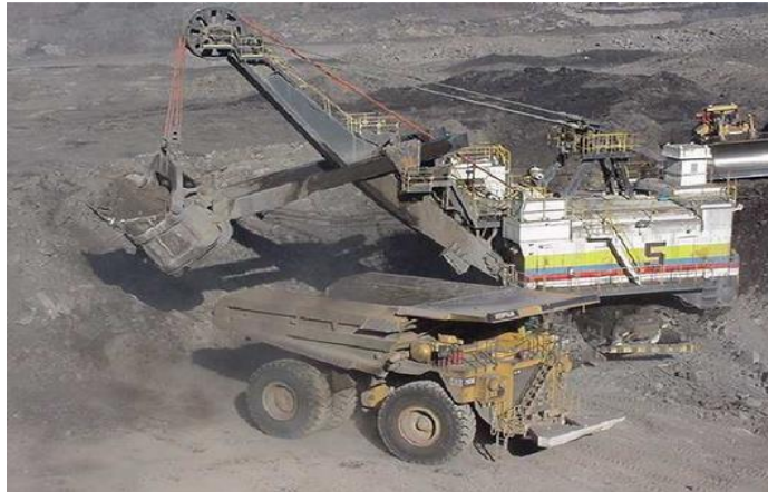
Figura 3. Cargue de camiones con estéril con pala Eléctrica
