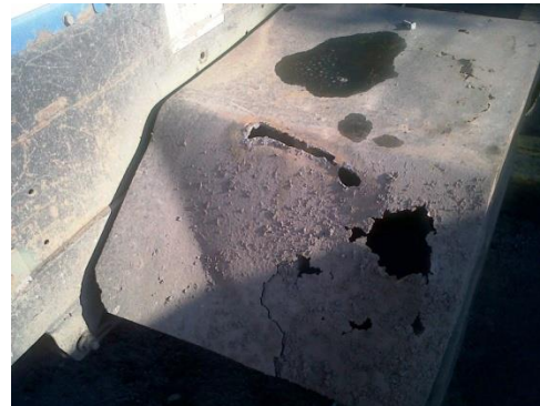
Figura 36. Corrosión y grieta en Motosoldador
