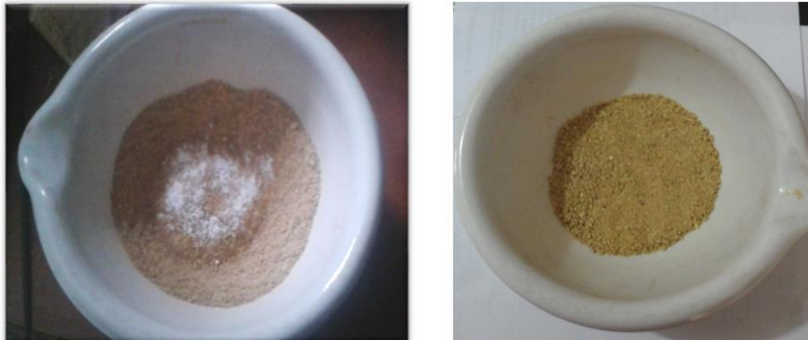
Figura 8. Procedimiento de homogenización Purina/Zeolita al 5%.
