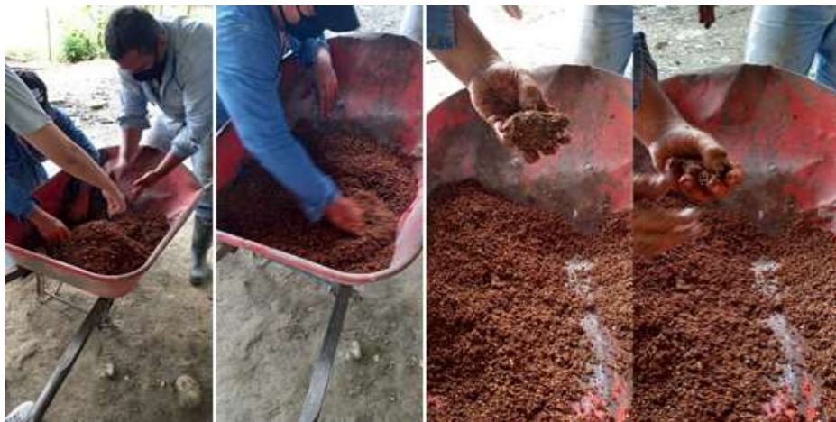
Imagen 13. Prueba de puño para la mezcla del Bloque
