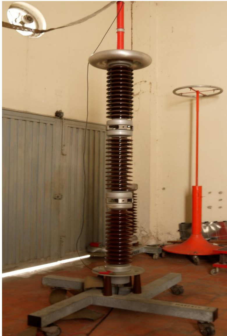
Figura 6. Divisor capacitivo amortiguado.
