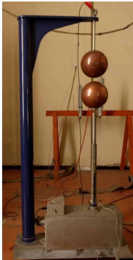
Figura 7. Espinterómetro laboratorio UIS.
