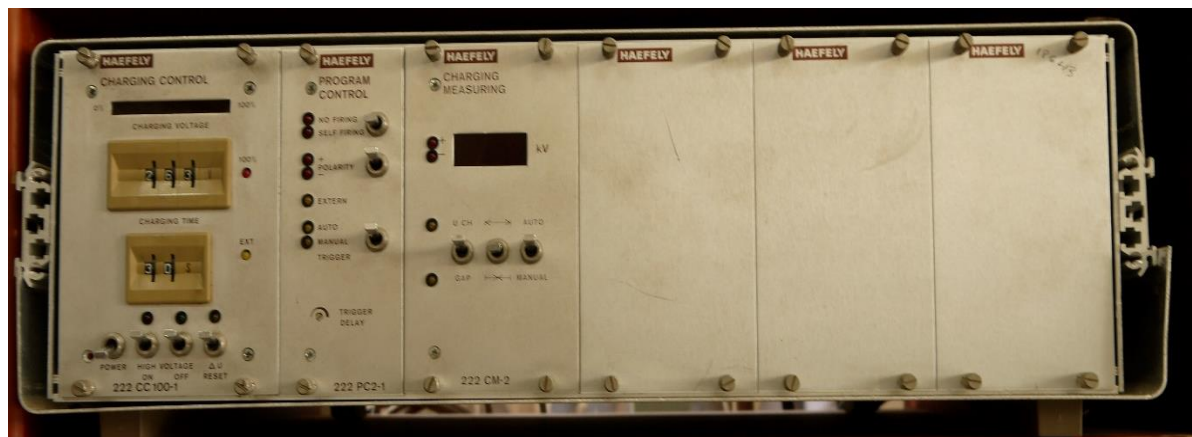
Figura 5. Consola de mando del generador laboratorio UIS.
