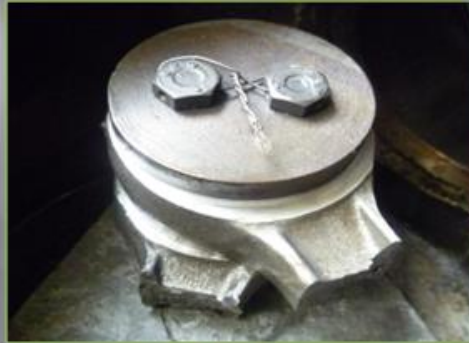
Daño severo (Ruptura) de las 2 bielas del compresor.
