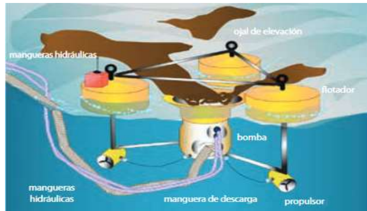
FIGURA 8. Esquema de un Skimmer tipo vertedero
