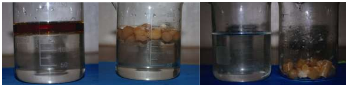
FIGURA 13. Aplicación de aerogeles para remoción de hidrocarburos en agua 6 .
