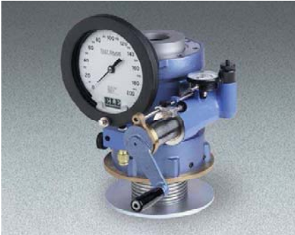
Figura 2. Estabilimetro de Hveem
