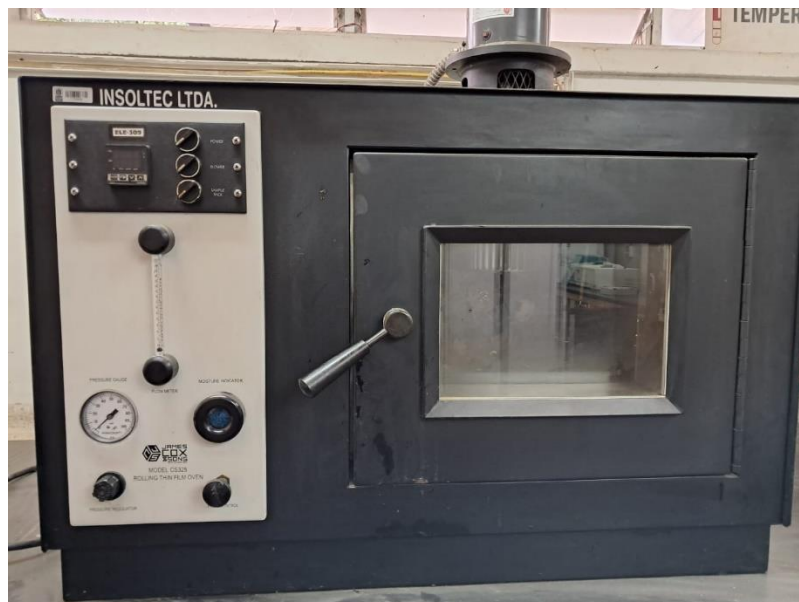
Apéndice A: Horno Rotatorio de Pelicula Delgada (RTFOT)
