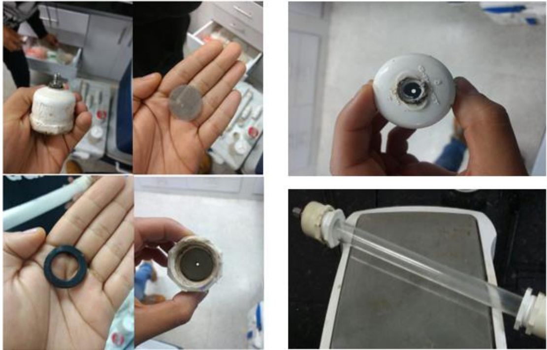
Figura 21. Materiales necesarios para la construcción de los empaques de arena.
