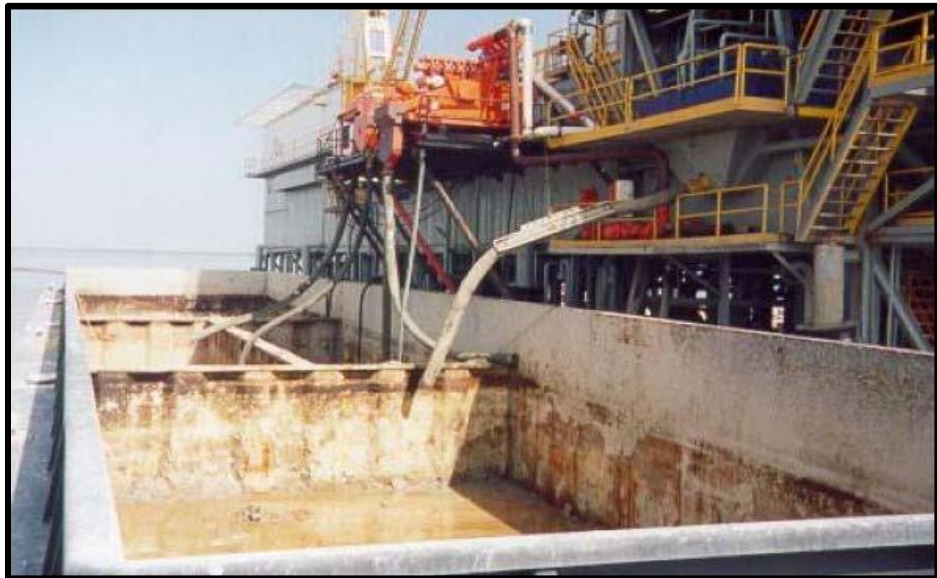
Figura 13. Sistema de colección por gravedad
