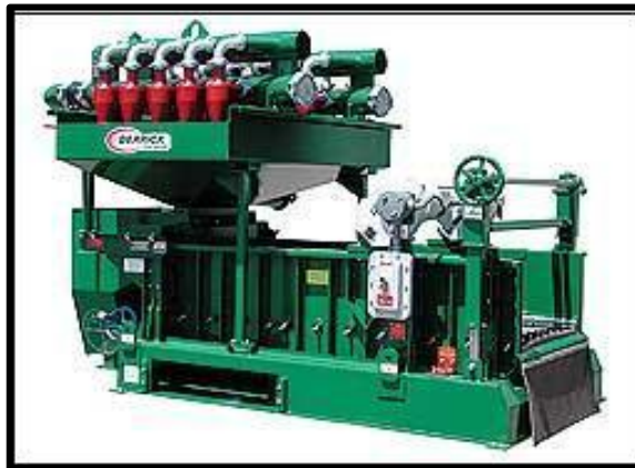
Figura 5. Equipo general de los hidrociclones
