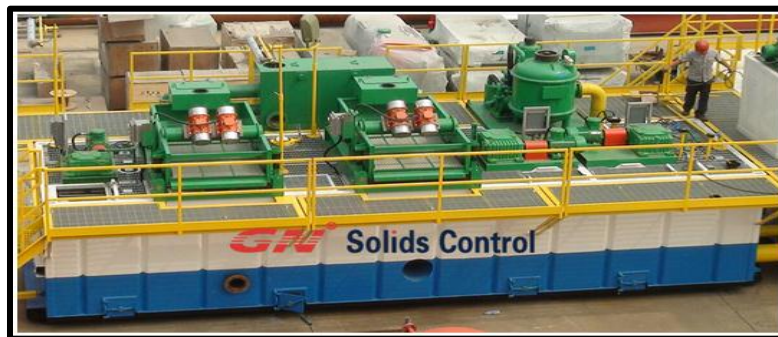
Figura 2. Equipo de control de sólidos
