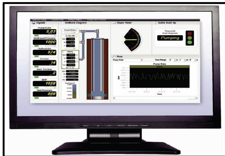
Figura 71. Monitoreo del proceso de inyección.
