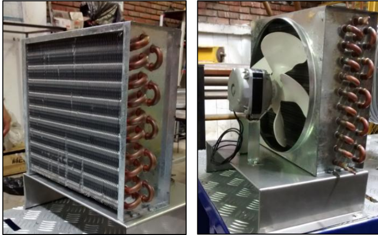
Figura 75. Condensador y ventilador seleccionado.
