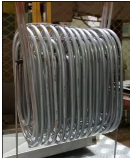
Figura 73. Evaporador del deshumidificador.
