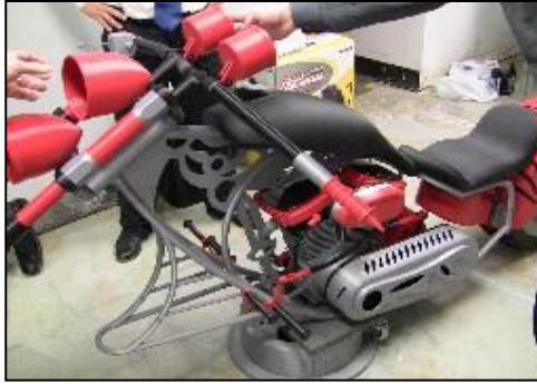
Figura 3. Foto de una motocicleta a escala real creada mediante FDM.
