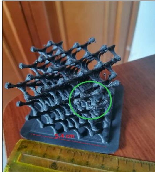
Figura 32. Modelo fallado con relación de diámetros de 3.
