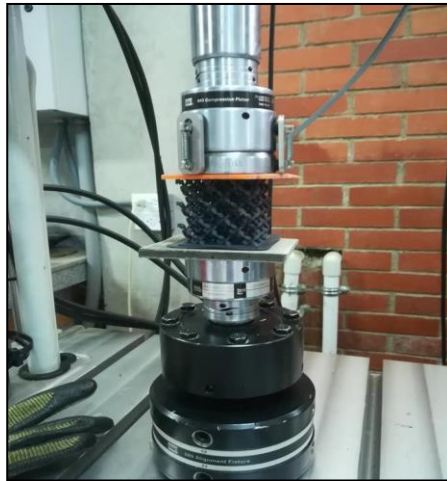
Figura 26. Ensayo a compresión del modelo con relación de diámetros de 0.18.
