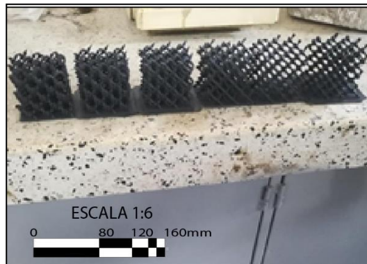
Figura 23. Modelos impresos con relación de diámetros de 0.18, 0.38, 0.53, 1, 2 y 3, de izquierda a derecha.
