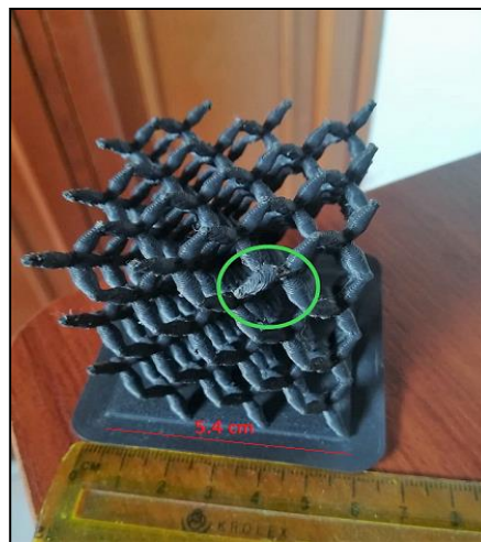
Figura 31. Modelo fallado con relación de diámetros de 0.53.
