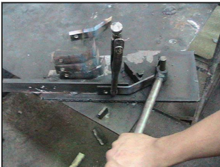
Figura 100. Dispositivo para doblado de cuchillas
