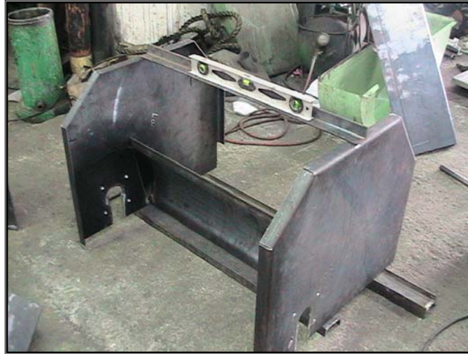
Figura 98. Verificación de la geometría del bastidor
