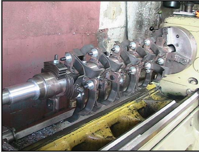
Figura 107. Rotor montado en torno
