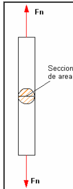
Figura 54. DCL del eje pasante de sujeción
