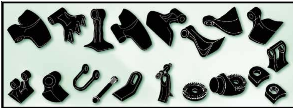
Figura 24. Diferentes elementos de corte utilizados en las trituradoras de eje horizontal
