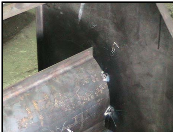
Figura 97. Puntos de soldadura entre piezas
