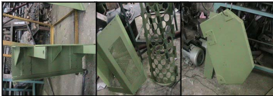
Figura 115. Piezas con anticorrosivo aplicado
