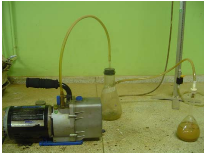
Figura 54. Remoción de aire atrapado en el picnómetro.
