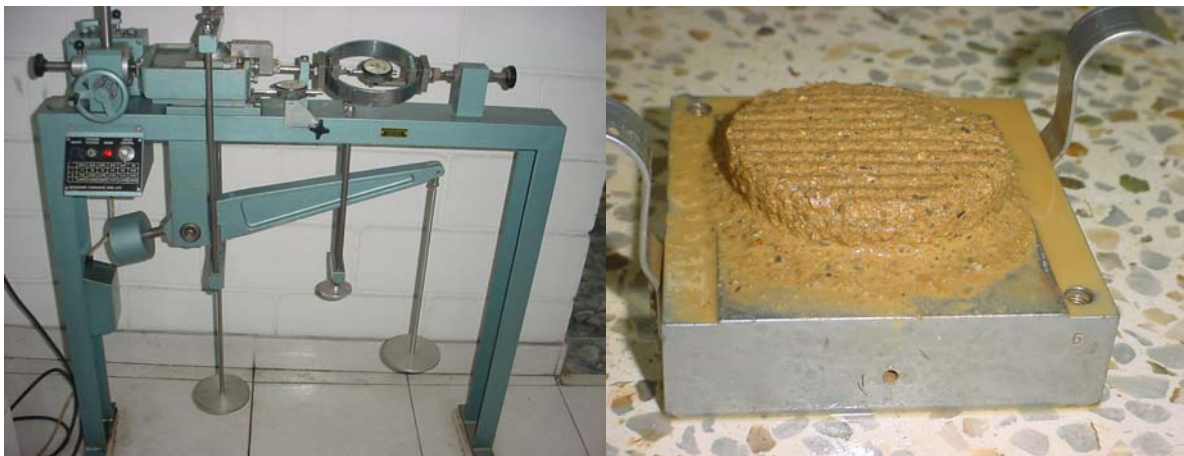
Figura 56. a) Equipo de corte directo. b) Muestra después del ensayo.
