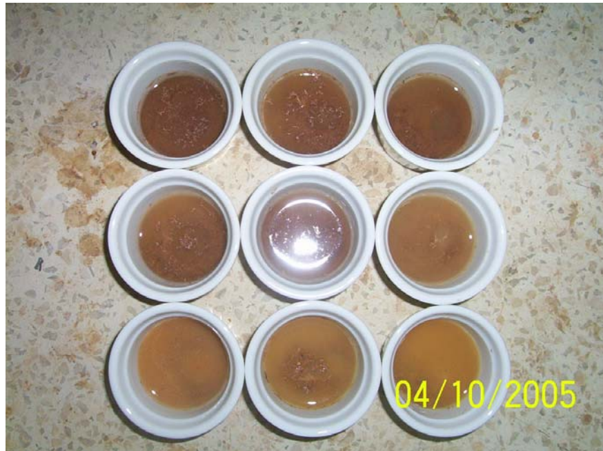
Figura 67. Soluciones de suelo para determinación de pH.
