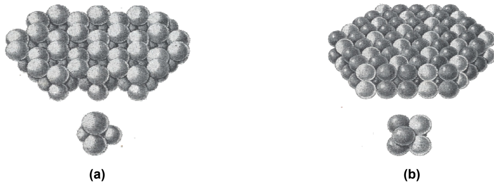
Figura 13. Esquema de: (a) Celda unitaria sílice-oxígeno y lámina tetraedral y (b) Celda unitaria aluminio-oxígeno y lámina octaedral.
