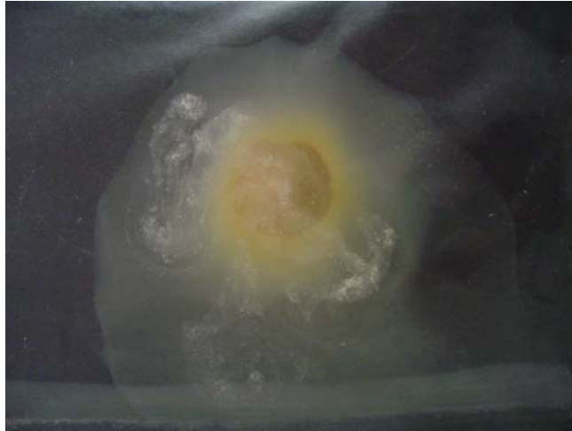
Figura 12. Grumo de suelo en agua durante ensayo de dispersión.
