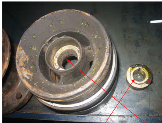
Cojinete ARZ de la cabeza atascado y roto por Scale
