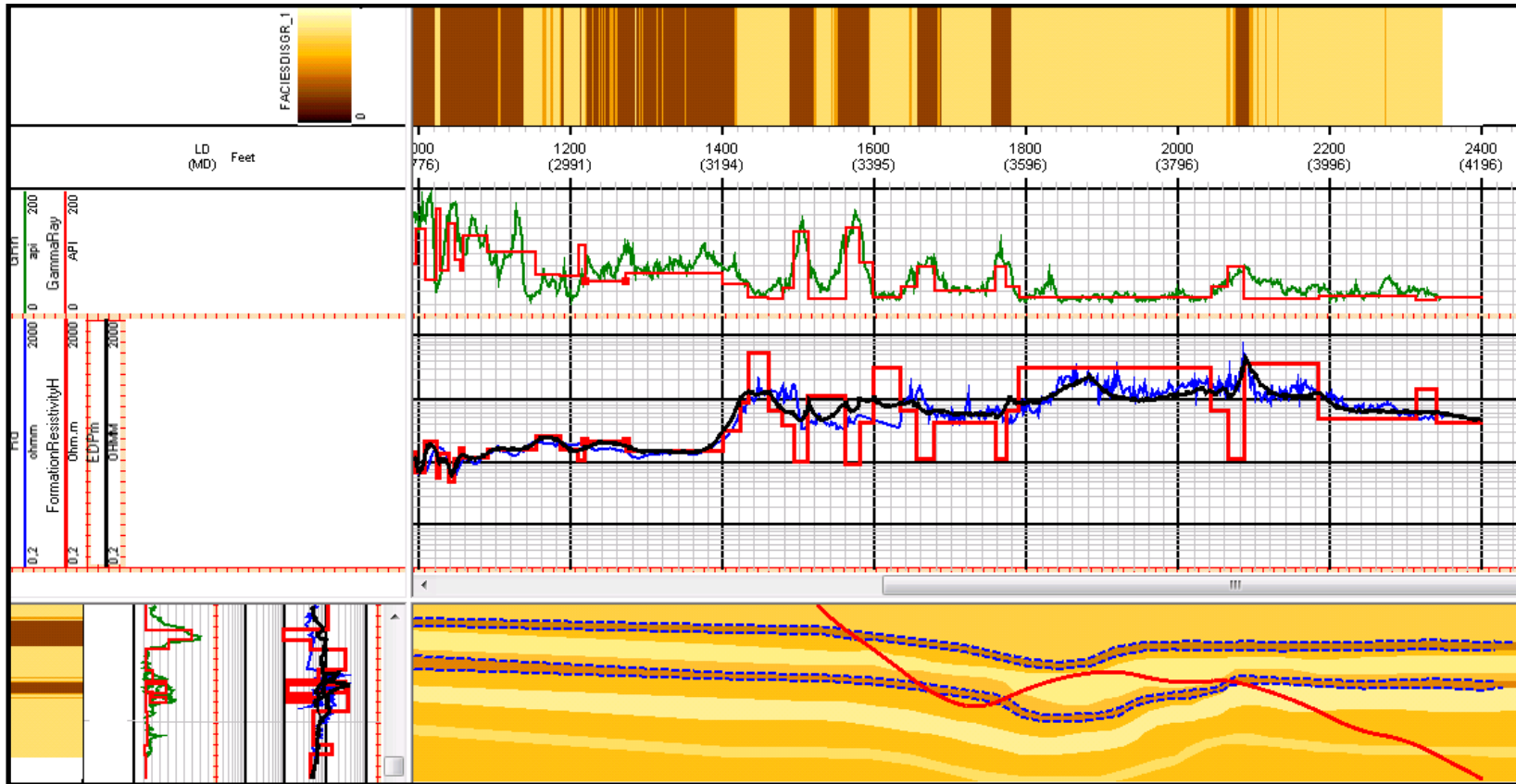
Figura 65. Set de registros del modelo final. Se muestra la resistividad verdadera (registro rojo), la resistividad original (registro azul) y la resistividad simulada (registro negro).
