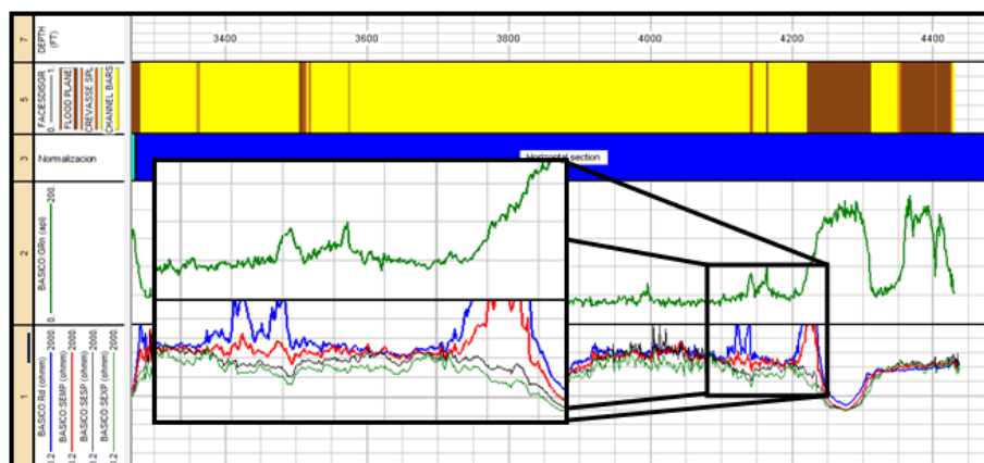
Figura 17. Registros de gamma ray y resistividad corridos en el pozo JA-207H. Las curvas de las diferentes profundidades de investigación se encuentran separadas y con diferentes irregularidades en cada profundidad de investigación.
